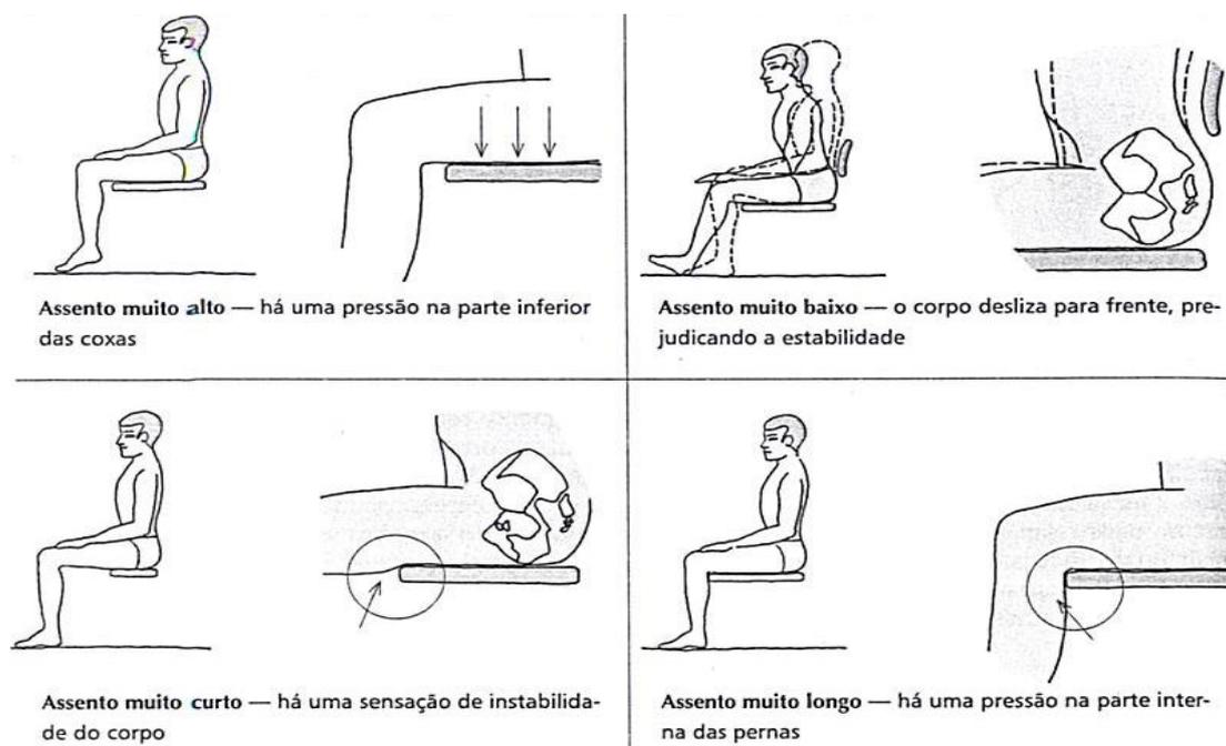
Figura 7: Principais problemas provocados por erros no dimensionamento de assentos.
